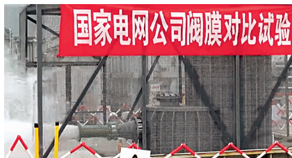
(a) 爆破片型压力泄放装置泄压效果
